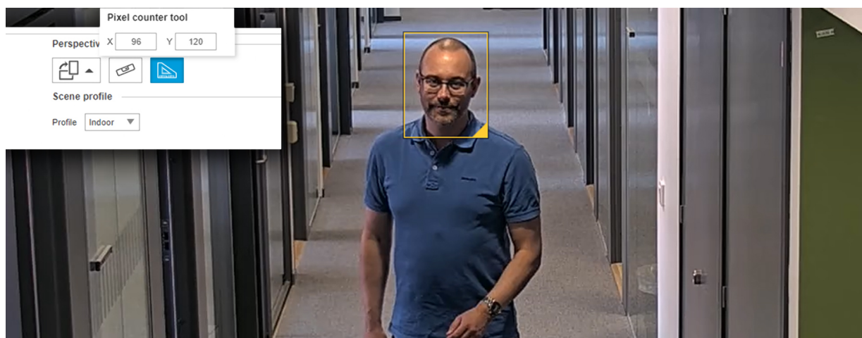
Figure 4. Widok z kamery z widocznym licznikiem pikseli. Narzędzie pokazuje, że ramka ma szerokość 96 pikseli, co oznacza możliwość identyfikacji (która wymaga minimum 40 pikseli przypadających na szerokość twarzy).
