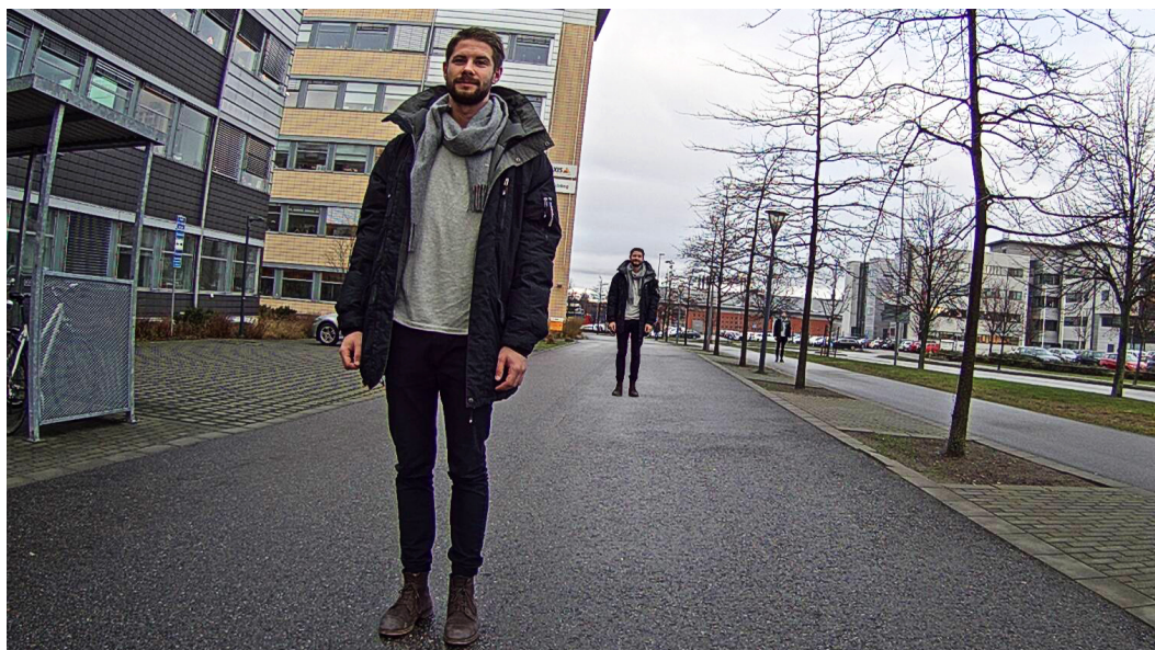
Figure 1. Połączenie trzech zdjęć tej samej osoby reprezentujące trzy kryteria wymagań użytkowych. Osoba stojąca najbliżej kamery znajduje się wystarczająco blisko do celów identyfikacji. W przypadku osoby stojącej pośrodku możliwe jest rozpoznanie, a w przypadku osoby stojącej najdalej – wyłącznie detekcja.
