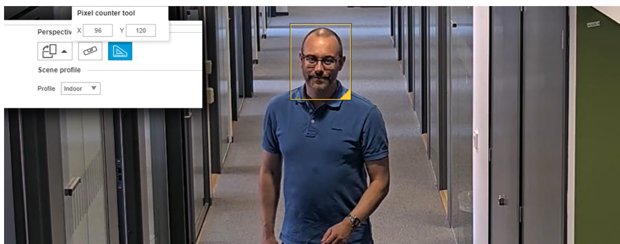
Figure 4. Imagens da câmera com o contador de pixels visível. A ferramenta mostra que temos 96 pixels na moldura, o que significa que a identificação é possível (são necessários pelo menos 40 pixels no rosto).
