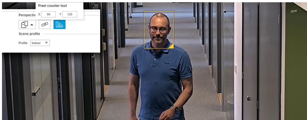
Figure 4. Поле обзора камеры со счетчиком пикселей. Здесь видно, что ширина рамки составляет 96 пикселей, а это значит, что идентификация возможна (требуется не менее 40 пикселей поперек лица).
