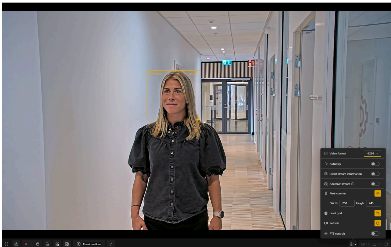
Figure 4.2 Champ de la caméra où le compteur de pixels est visible. L'outil indique qu'il y a 96 pixels dans l'image, ce qui signifie que l'identification est possible (il faut au moins 40 pixels sur le visage).
