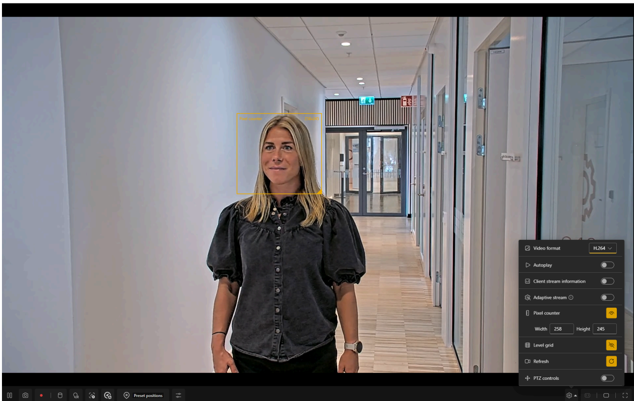
Figure 4.2 Champ de la caméra où le compteur de pixels est visible. L'outil indique que l'image compte 258 pixels, ce qui signifie que la validation est possible (le visage doit comporter au moins 80 pixels).
