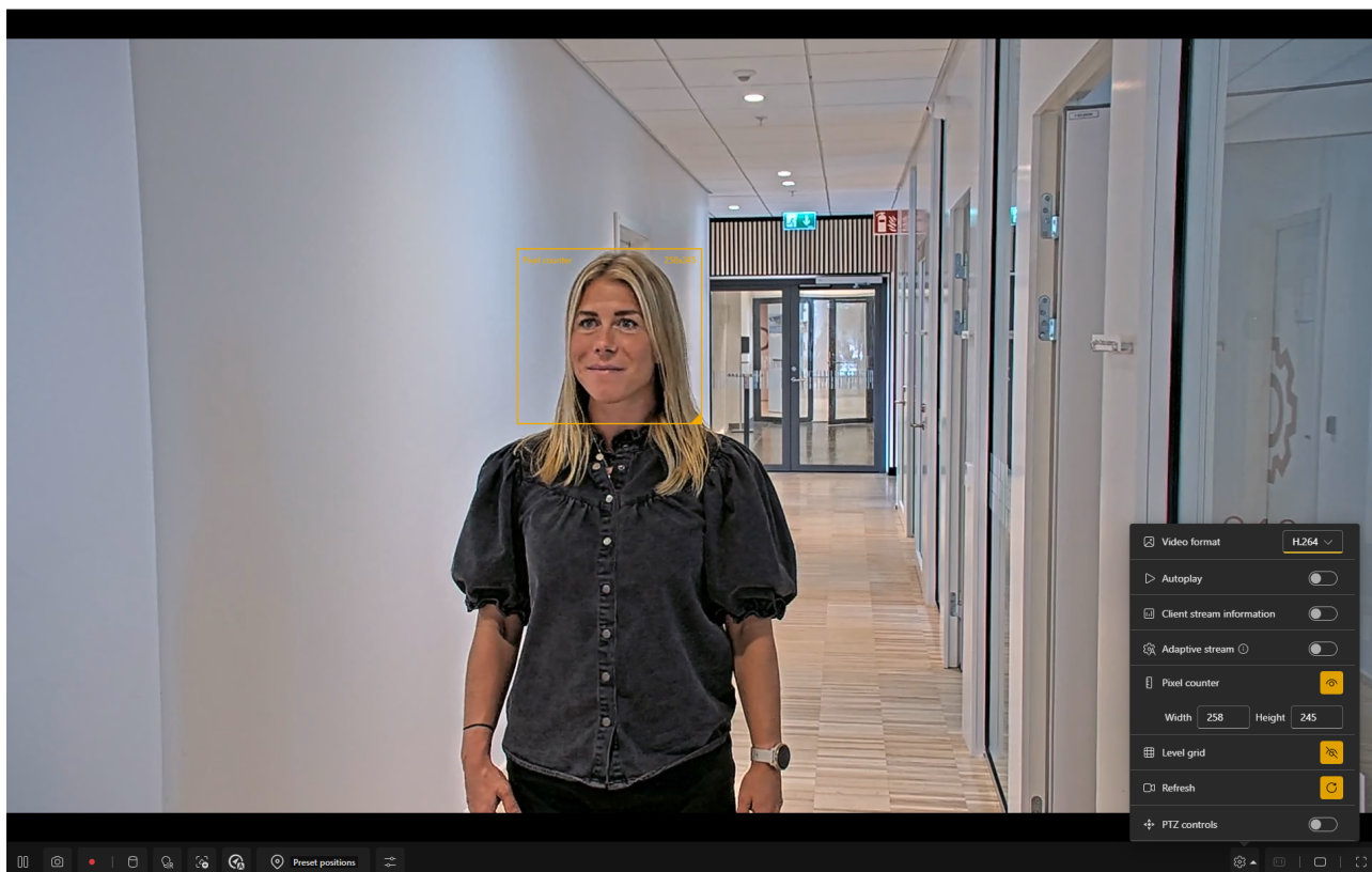
図 4.2 ピクセルカウンターを表示したカメラビュー。ツールは、フレームの水平方向のピクセル数が96、つまり識別が可能であることを示しています (要件: 顔の水平方向のピクセル数が40以上)。
