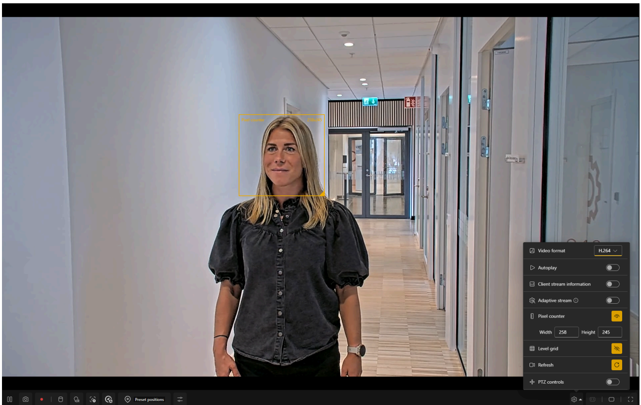
図 4.2 ピクセルカウンターを表示したカメラビュー。ツールは、フレームの水平方向のピクセル数が258、つまり情報検証が可能であることを示しています (要件: 顔の水平方向のピクセル数が80以上)。
