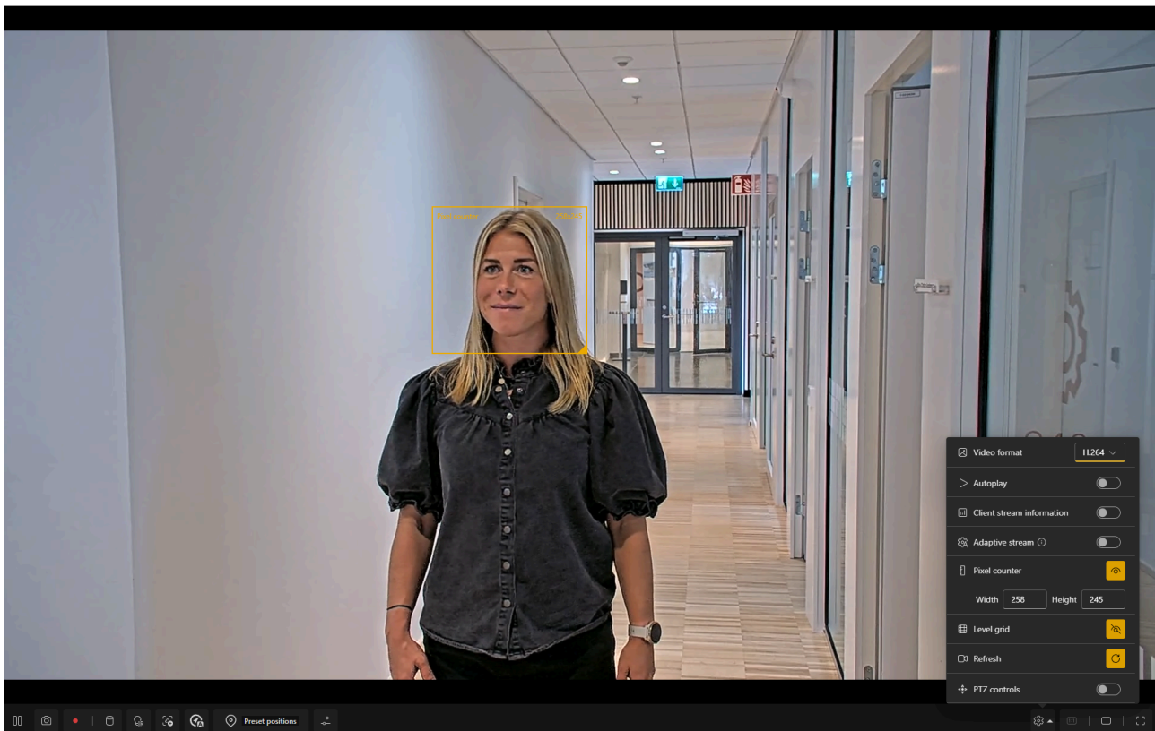
Figura 4.2 Imagens da câmera com o contador de pixels visível. A ferramenta mostra que temos 258 pixels em toda a moldura, o que significa que a validação é possível (exigindo pelo menos 80 pixels em todo o rosto).
