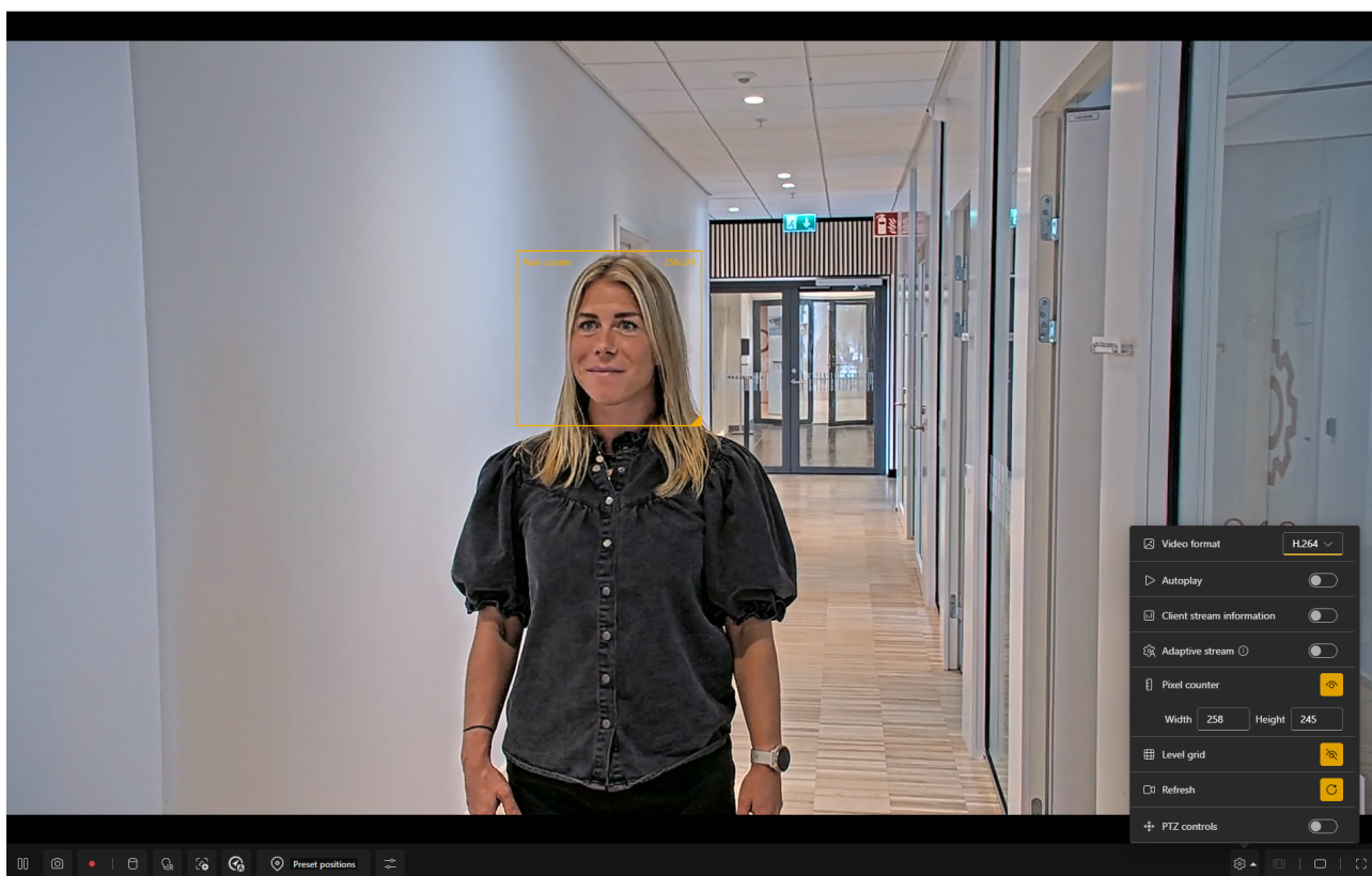
图 4.2 显示了像素计数器的摄像机画面。此工具显示，边框范围内有96个像素，这就意味着，可以达到辨认目的（其要求人脸至少包含40个像素）。
