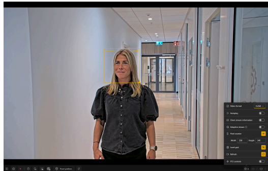
Figura 4.2 Una vista della telecamera con il contatore di pixel visibile. Lo strumento indica che la cornice misura 258 pixel in larghezza: la validazione, che richiede almeno 80 pixel in larghezza sul volto, è quindi possibile.
