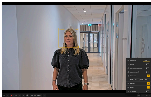
그림 4.2 픽셀 카운터가 표시되는 카메라 영상. 이 도구에 프레임 폭 기준으로 258픽셀이 표시되므로 검증이 가능합니다(얼굴 폭 기준으로 최소 80픽셀 필요).
