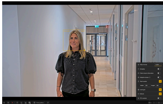
图 4.2 显示了像素计数器的摄像机画面。此工具显示，边框范围内有258个像素，这就意味着，可以达到验证目的（其要求人脸至少包含80个像素）。
