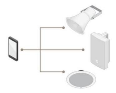
他社のSIPアプリを利用して、Axisスピーカーからアナウンスを流すことができます。電話通信やユニファイドコミュニケーション機器メーカーのほとんどは、スマートフォン用の独自のアプリを製造しています。アプリでSIPプロトコルがサポートされていれば、Axis IPスピーカーとも互換性がある可能性があります。Axisはこうしたアプリの互換性をテストしていないため、ご自身またはインテグレーターが慎重にアプリを選択してください。
