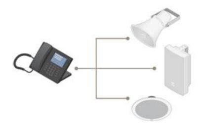
現在、ほとんどのオフィスの電話はSIPと互換性があります。そのため、標準のSIP電話を使用して、Axis IP音声デバイスのSIPアドレスを呼び出すことができます。
