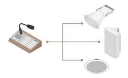
放送設備(PA)システムにより、スタジアム、学校、ショッピングモールといった場所でお知らせを放送することができます。最新のIPベースのPAシステムは、IP音声デバイス(通常はマイクとスピーカー)およびデバイスに統合できる音声管理ソフトウェアで構成されています。お知らせはライブで放送すること、スケジュールに従って再生すること、また特定のイベントに応じてトリガーすることができます。
