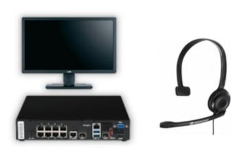
AxisまたはAxisソフトウェアパートナーのビデオ管理システムを使用している場合は、USB ヘッドセットをVMS(ビデオ管理システム)クライアントに接続することができます。 VMSクライアントのヘッドセットとウェブボタンを使用して、Axis IPスピーカーからアナウンスを行うこと、および音声クリップをトリガーすることが可能です。この機能は、 AXIS Camera StationとAXIS Companion、またAxisソフトウェアパートナーのVMSソリューションの多くでサポートされています。
