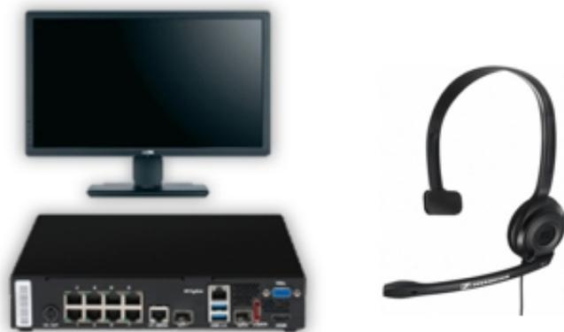
如果您使用安讯士或安讯士软件合作伙伴的视频管理系统，您可以将USB耳机连接到VMS（视频管理系统）客户端。通过VMS客户端上的耳机和Web按钮，可以向安讯士IP扬声器发出通知或触发音频剪辑。AXIS Camera Station、AXIS Companion和安讯士软件合作伙伴的许多VMS解决方案都支持此功能。
