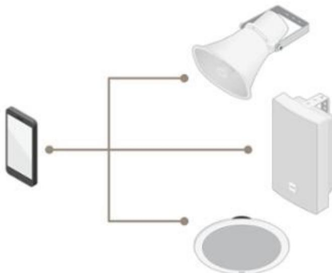
有些第三方SIP应用程序可以用于向安讯士扬声器发出通知。大多数电话和统一通信设备制造商也有自己的智能手机应用程序。如果这些应用程序支持SIP协议，它们也可以与安讯士IP扬声器兼容。安讯士未测试这类应用程序的兼容性，所以应由您或您的集成商进行测试。
