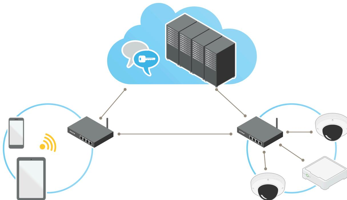
Figure 3. Comunicación segura de punto a punto entre un cliente y una cámara situada en redes diferentes.
