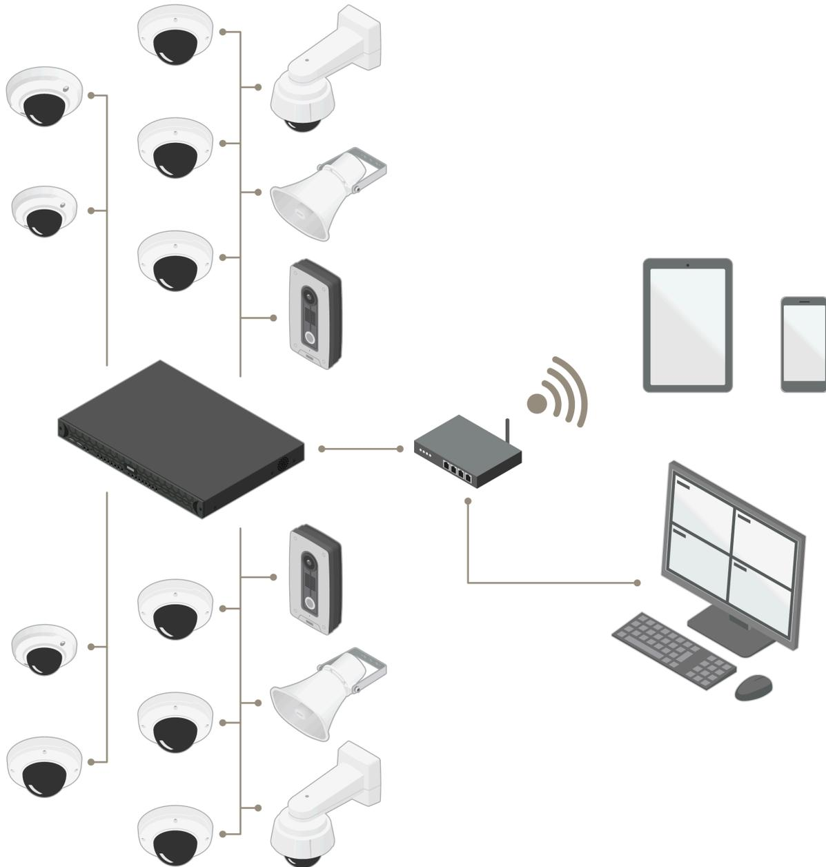
Figure 4. Ilustración de una instalación con AXIS Camera Station en un sistema con AXIS S2016 con switch PoE integrado, 16 dispositivos y clientes operador.
