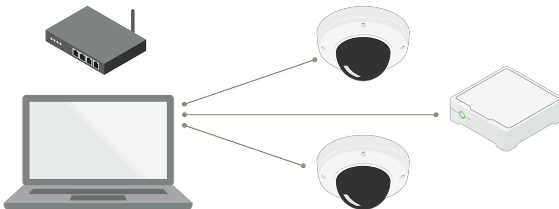
Figure 2. Configuración del sistema cuando el cliente y la cámara se encuentran en la misma red.
