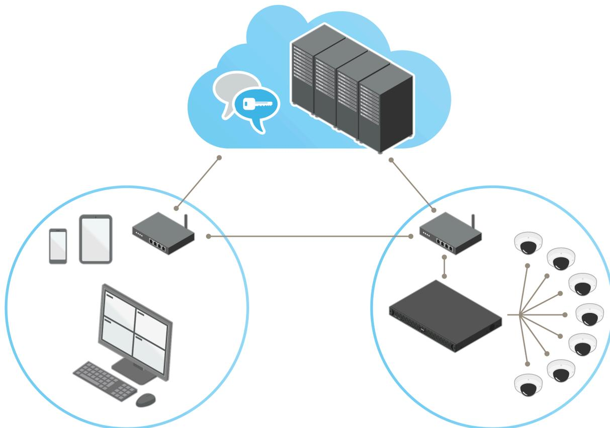
*Figure 5. Comunicaci3n segura de punto a punto entre un cliente y un servidor ubicados en redes diferentes, y respaldo a la comunicaci3n retransmitida.*
