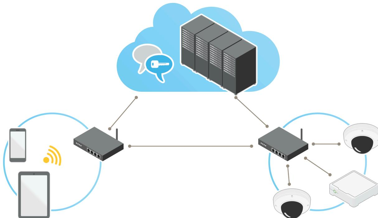
Figure 3. 異なるネットワーク上にあるクライアントとカメラ間のセキュアなピアツーピア通信。
