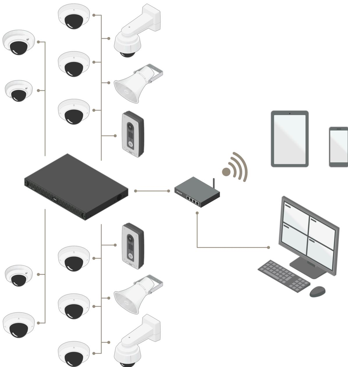
Figure 4. PoEスイッチ、16台のデバイス、オペレータークライアントを統合したAXIS S2016で動作するシステムにAXIS Camera Stationを設置した場合の図
