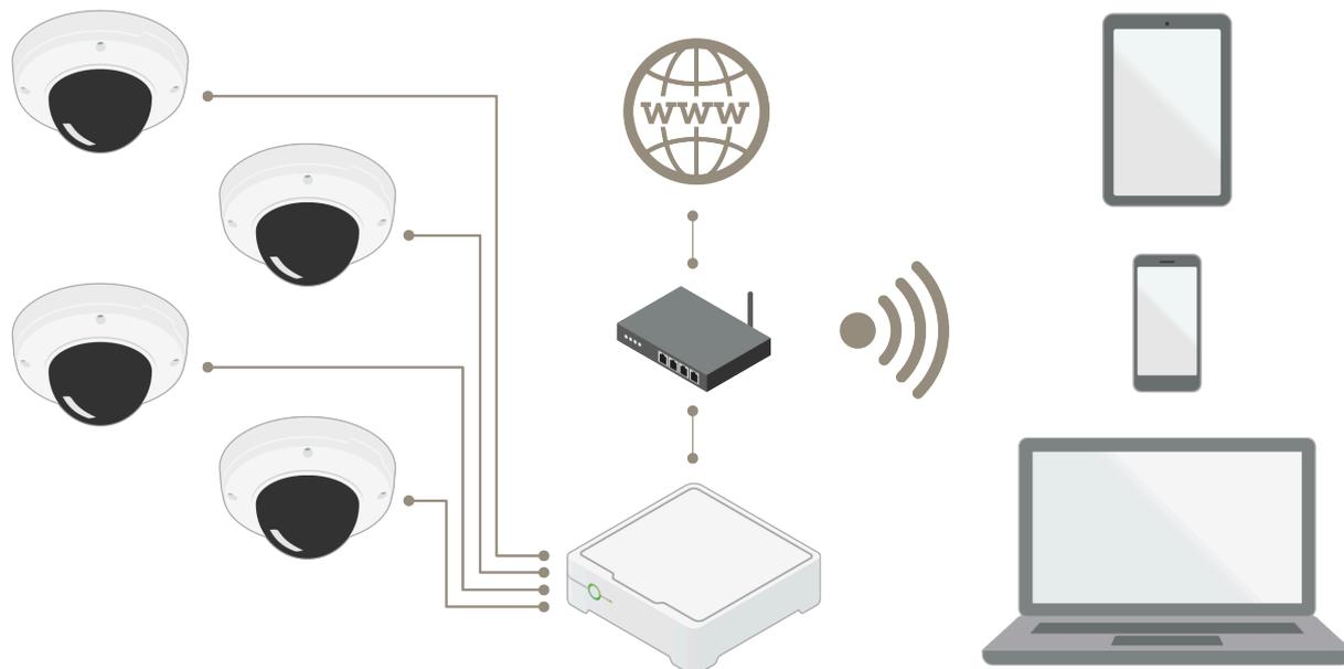
Figure 1. 4台のカメラ、SDカードのストレージ、PoEスイッチ、ルーター、クライアントを備えたAXIS Companionシステムの図。
