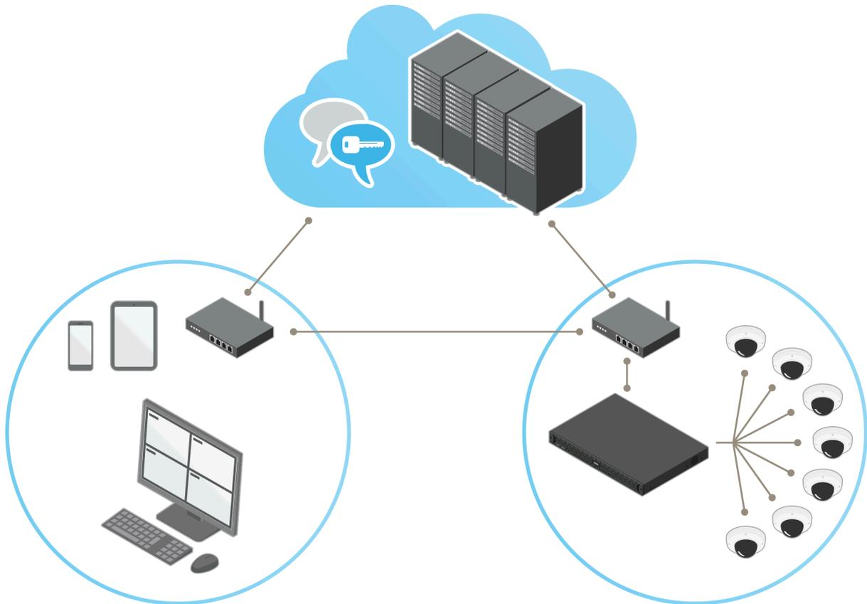
Figure 5. 異なるネットワーク上にあるクライアントとサーバー間のセキュアなピアツーピア通信と、中継通信へのフォールバック。
