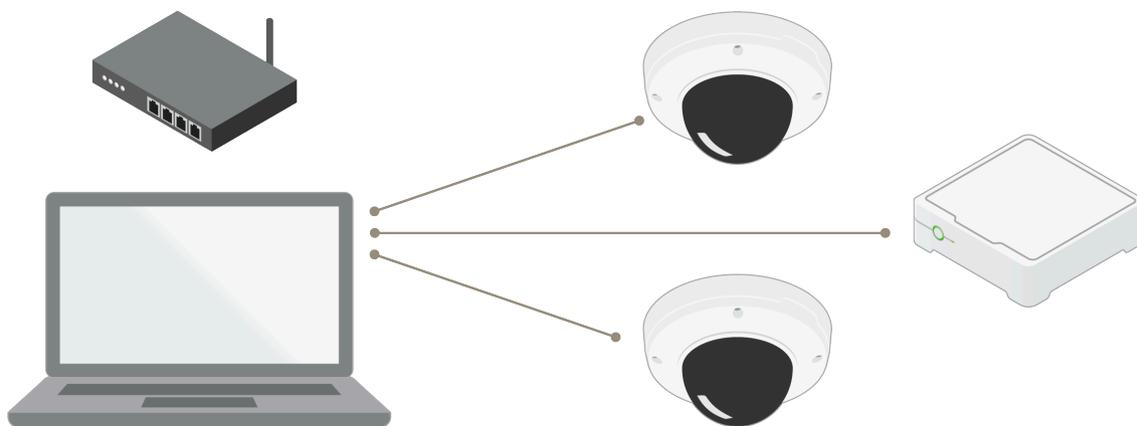
Figure 2. クライアントとカメラが同じネットワーク上にある場合のシステム設定。
