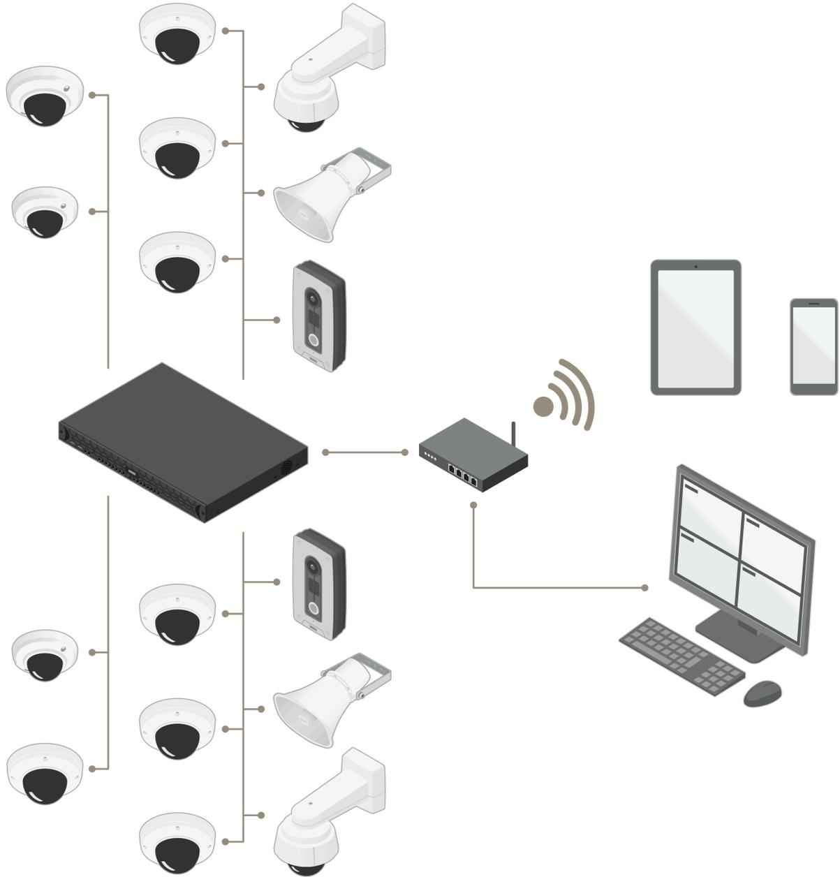
Figure 4. 통합 PoE 스위치, 16개의 장치 및 운영자 클라이언트가 있는 AXIS S2016에서 운영되는 시스템에 AXIS Camera Station을 설치한 그림입니다.
