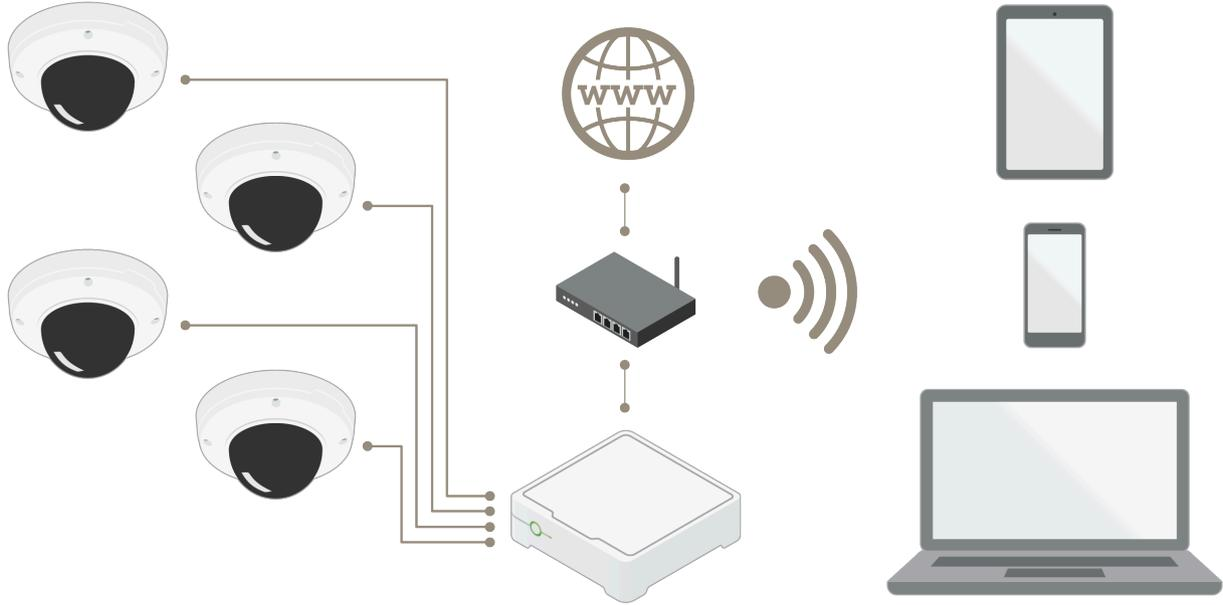
Figure 1. 카메라 4대, SD 카드 스토리지, PoE 스위치, 라우터 및 클라이언트가 있는 AXIS Companion 시스템의 그림입니다.
