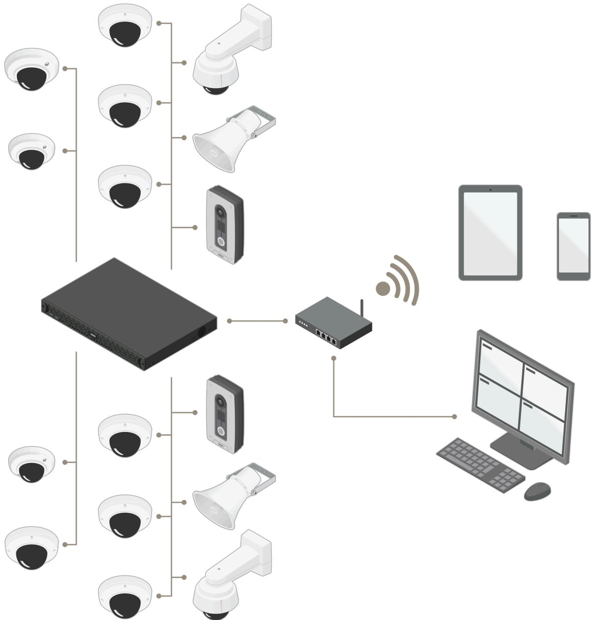
Figure 4. AXIS Camera Station 安装在运行 AXIS S2016 的系统上的示意图，该系统集成了 PoE 交换机、16 台设备和操作员客户端。
