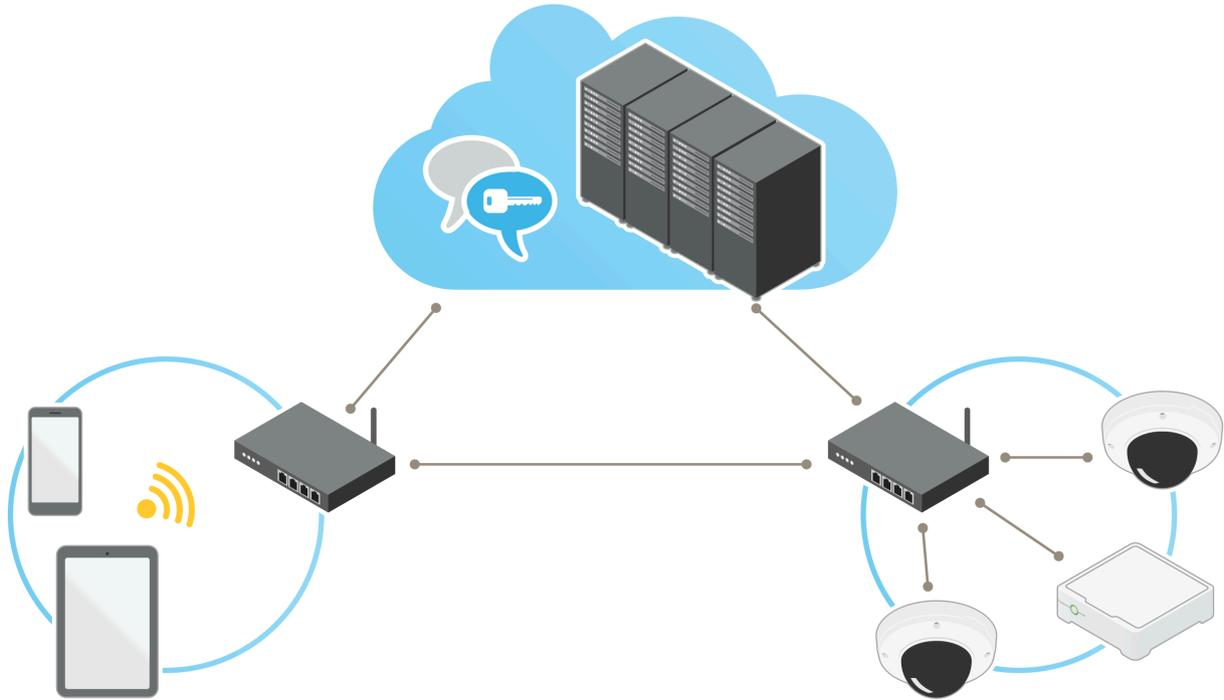
Figure 3. 在位于不同网络的客户端和摄像机之间进行安全的点对点通信。
