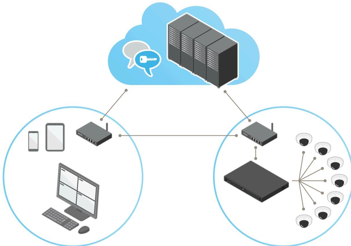
Figure 5. 在位于不同网络的客户端和服务端之间进行安全的点对点通信，并以中继通信作为备用方案。
