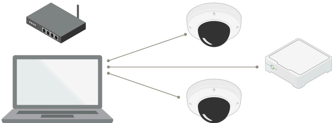
Figure 2. 客户端和摄像机处于同一网络中时的系统设置。
