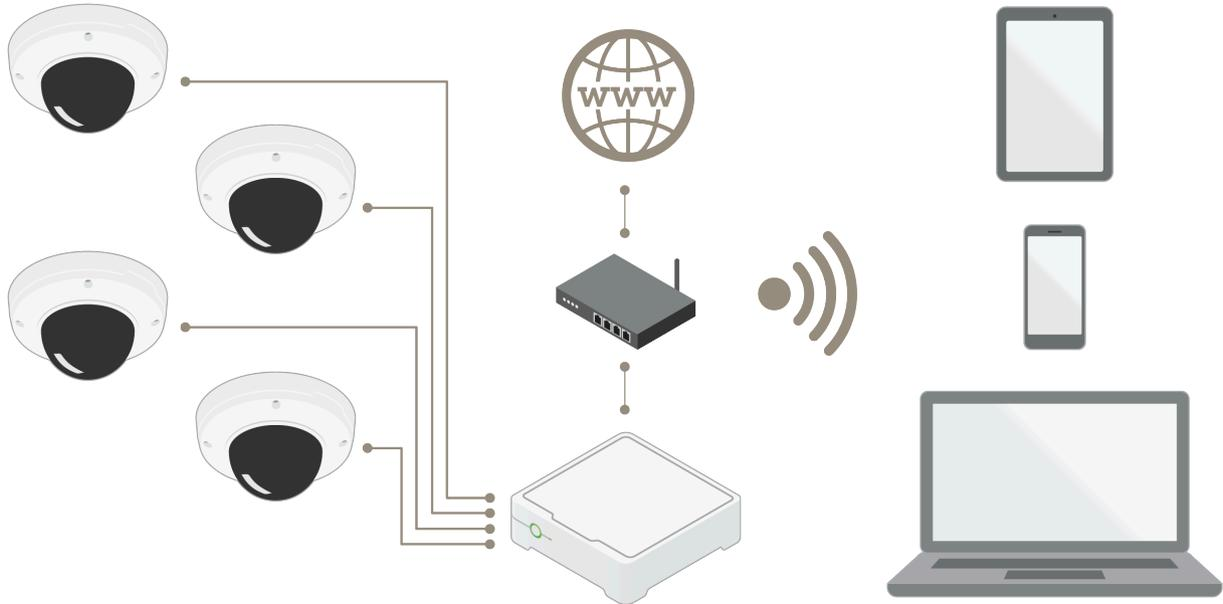
Figure 1. AXIS Companion 系统示意图，包括四台摄像机、SD 卡存储、PoE 交换机、路由器和客户端。
