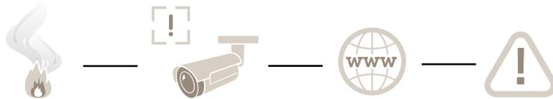
*Eine Videokamera erkennt einen Brand und kann verschiedene Reaktionen über das Netzwerk auslösen.*
