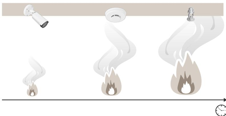
基于视频的火灾探测有着比传统烟雾探测器更快的响应速度。
