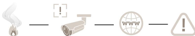
*火灾探测由视频摄像机执行，它能够通过网络触发多种类型的响应。*
