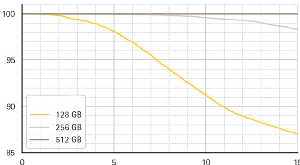
監視カード寿命の累積パーセンタイルプロット (0~15年後に何パーセントのカードがまだ機能しているかを示す)。実データと推定に基づくシミュレーション。
