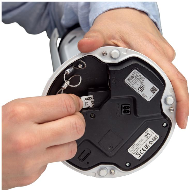
Axis監視カードは、監視カメラの典型的なメモリ書き込み動作に合わせて特別に開発された耐久性の高いmicroSDXC™カードです。民生用SDカードよりも大幅に多く書き込みや上書きができます。そのため、消耗することなく、同じカードを長期間にわたりカメラに装着することができます。Axis監視カードには5年保証が付いていますが、256 GB以上のストレージを搭載したバージョンでは、一般的に10年以上、またはカメラの通常の耐用年数まで使用し続けられることが実証されています。
