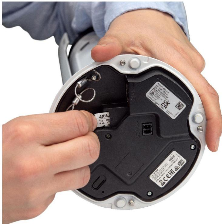
Axis 감시 카드는 감시 카메라의 일반적인 메모리 쓰기 동작에 맞게 특별히 개발되고 내구성이 우수한 microSDXC™ 카드입니다. 일반 소비자용 SD 카드보다 훨씬 더 많이 쓰고 덮어쓸 수 있습니다. 따라서 감시 카드는 마모되지 않고 더 오랜 시간 동안 카메라에 남아 있을 수 있습니다. Axis 감시 카드
