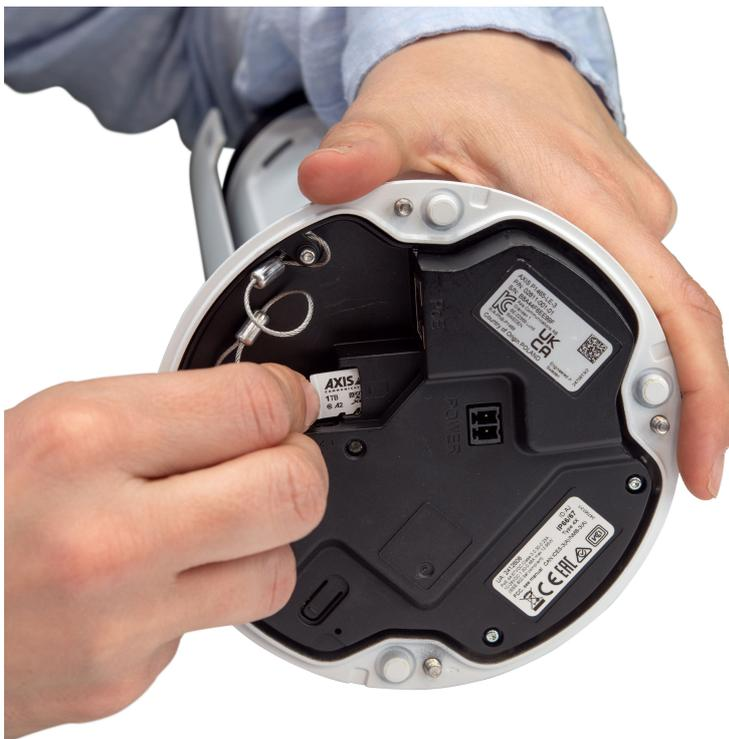
安讯士监控卡是高耐用性的 microSDXC™ 存储卡，专为配合监控摄像机的典型存储写入行为而开发。与消费级 SD 卡相比，它们可以进行更多次写入和覆盖。因此，同一张卡在不磨损状态下于摄像机中留用的时间更长。安讯士监控卡提供 5 年保修，但 256 GB 及更高存储容量的版本通常可以使用超过 10 年，或者与您常用的摄像机一样长的使用寿命。
