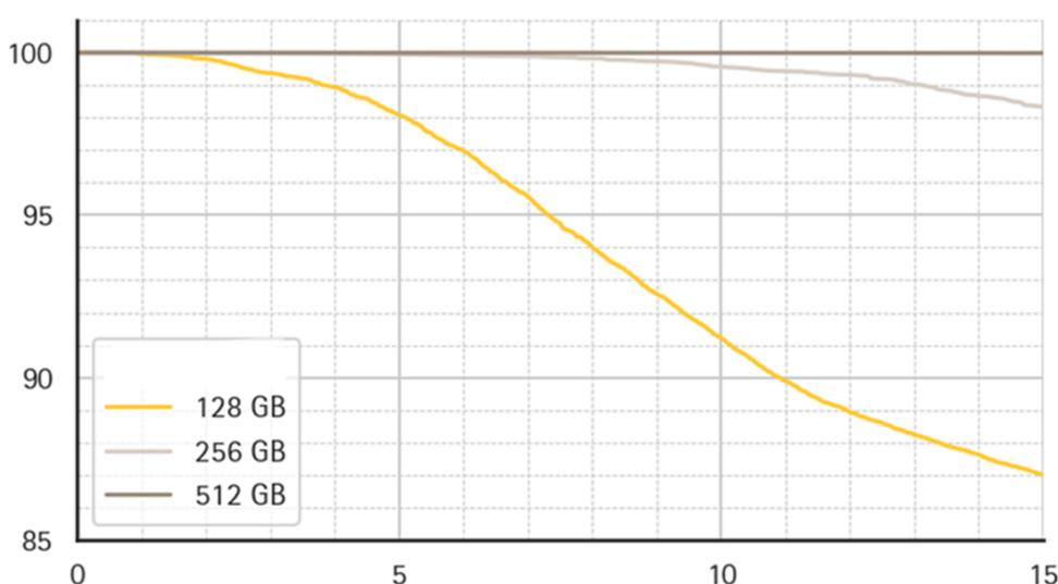
监控卡使用寿命累积百分位数图，显示 0–15 年后仍能正常运行的监控卡比例。基于真实数据和估算的模拟结果。
