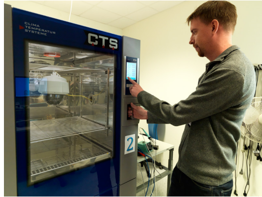
Figure 6. Temperaturtest in einer Klimakammer.
