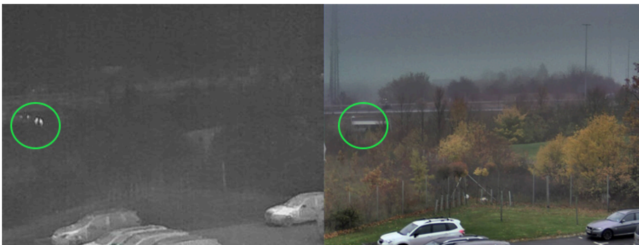
Bilder einer Wärmebildkamera (links) und einer visuellen Kamera (rechts) an einem regnerischen Tag. Die Personen (in der Kreismarkierung) sind mit der Wärmebildkamera leicht zu erkennen.
