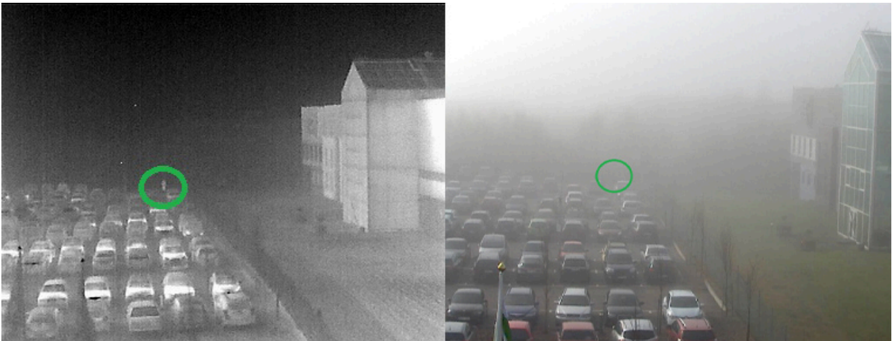
Bilder einer Wärmebildkamera (links) und einer visuellen Kamera (rechts) an einem nebligen Tag. Eine Person (Kreismarkierung) kann mit der Wärmebildkamera gesehen werden, nicht aber mit der visuellen Kamera.
