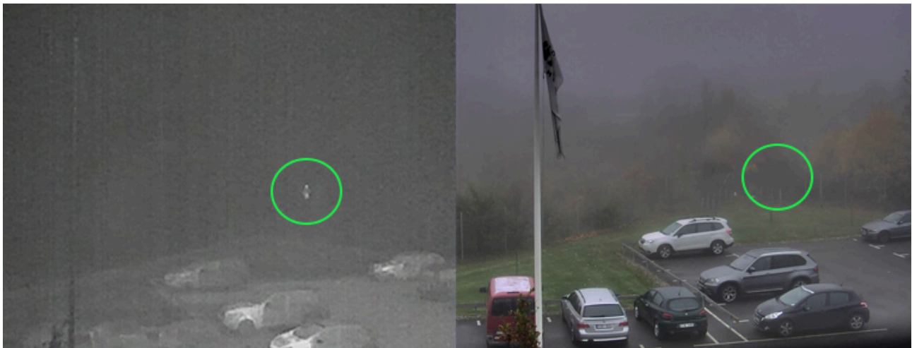
Bilder einer Wärmebildkamera (links) und einer visuellen Kamera (rechts) an einem nebligen Tag. Eine Person (in der Kreismarkierung) ist mit der Wärmebildkamera zu erkennen, nicht aber mit der visuellen Kamera.
