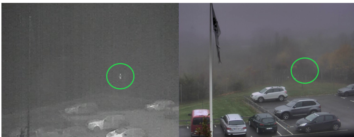
Imágenes de una cámara térmica (izquierda) y de una cámara visual (derecha) un día de niebla. Es posible distinguir a una persona (indicada con un círculo) con la cámara térmica pero no con la cámara visual.
