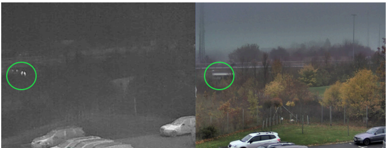
Imágenes de una cámara térmica (izquierda) y de una cámara visual (derecha) un día de lluvia. Las personas (dentro del círculo) pueden distinguirse fácilmente en la imagen de la cámara térmica.
