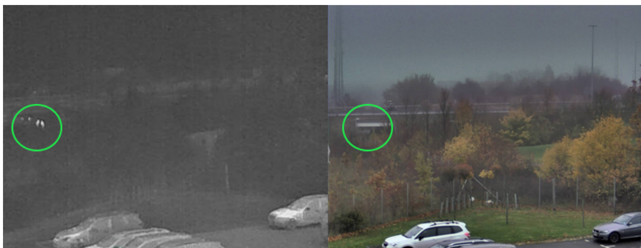
Images capturées par une caméra thermique (à gauche) et une caméra visuelle (à droite) par une journée pluvieuse. Les personnes (repérées par un cercle) sont facilement détectables avec la caméra thermique.
