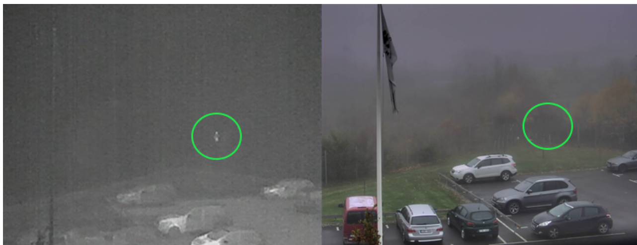
Images capturées par une caméra thermique (à gauche) et une caméra visuelle (à droite) par une journée brumeuse. Il est possible de distinguer une personne (repérée par un cercle) avec la caméra thermique, mais pas avec la caméra visuelle.
