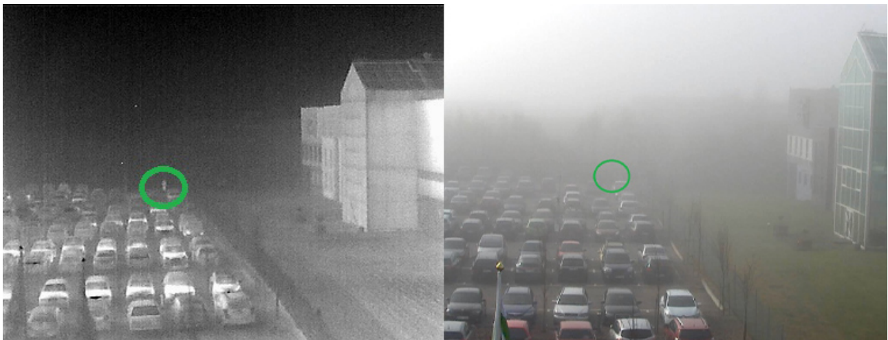
Images d'une caméra thermique (à gauche) et d'une caméra visuelle (à droite) par une journée brumeuse. Il est possible de distinguer une personne (repérée par un cercle) avec la caméra thermique, mais pas avec la caméra visuelle.
