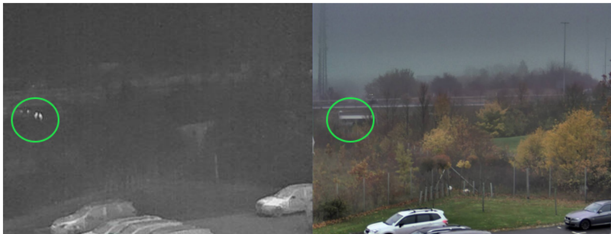
Immagini riprese con una telecamera termica (a sinistra) e una telecamera ottica (a destra) in un giorno di pioggia. Le persone (cerchiate) sono facilmente distinguibili con la telecamera termica.
