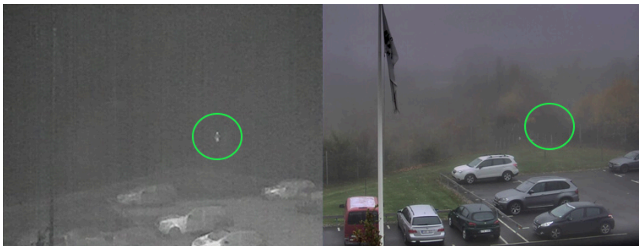
Immagini riprese con una telecamera termica (a sinistra) e una telecamera ottica (a destra) in presenza di nebbia. La persona (cerchiata) è distinguibile con la telecamera termica ma non con quella ottica.
