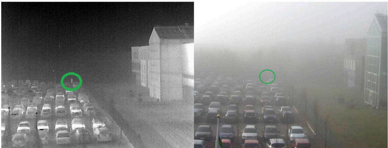
Immagine ripresa con una telecamera termica (a sinistra) e una telecamera ottica (a destra) in presenza di nebbia. La persona (cerchiata) è distinguibile con la telecamera termica ma non con quella ottica.
