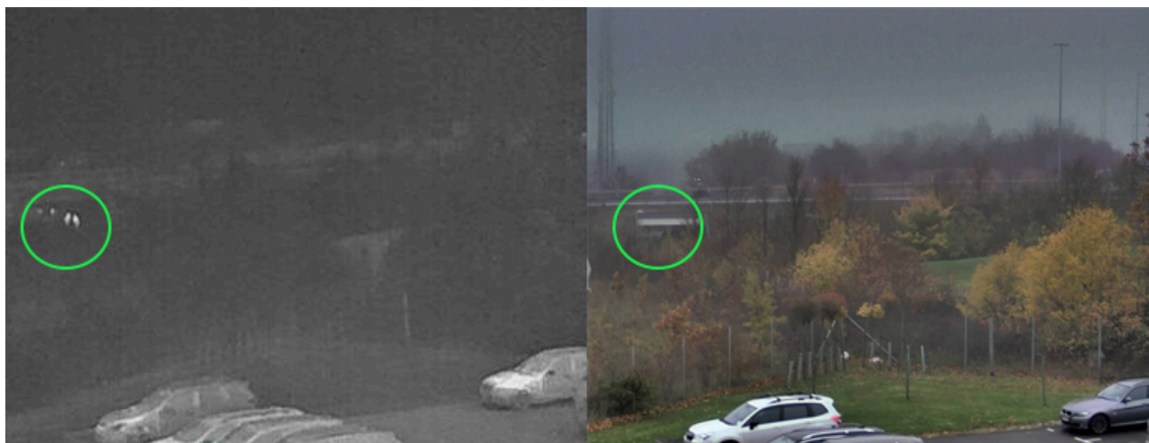
Obrazy z kamery termowizyjnej (po lewej) i kamery optycznej (po prawej) zarejestrowane w deszczowy dzień. Na obrazie z kamery termowizyjnej można łatwo dostrzec osoby (zaznaczone kółkiem).
