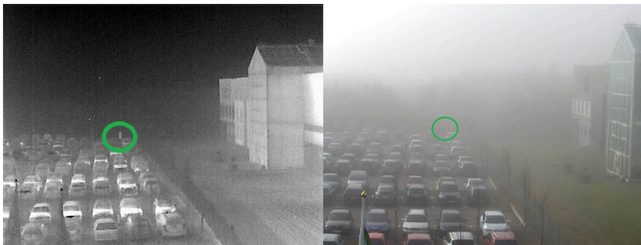
Obraz z kamery termowizyjnej (po lewej) i kamery optycznej (po prawej) zarejestrowany w mglisty dzień. W odróżnieniu od kamery optycznej kamera termowizyjna pozwala dostrzec osobę (zaznaczoną kółkiem).
