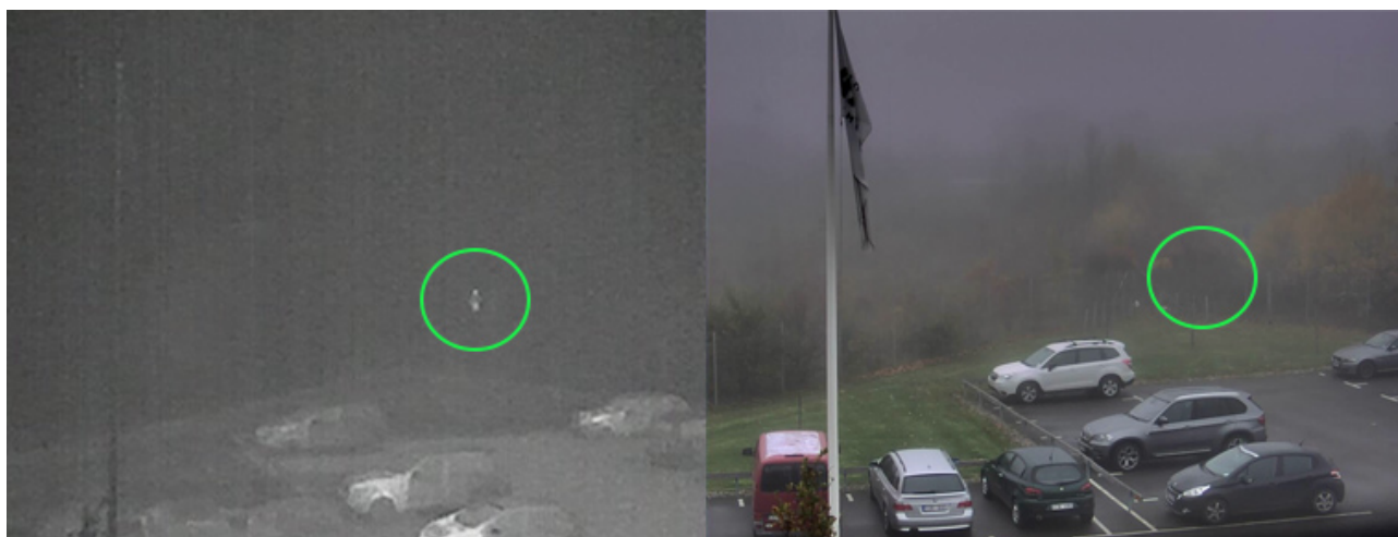
Imagens obtidas por uma câmera térmica (à esquerda) e uma câmera visual (à direita) em um dia de neblina. Um indivíduo (circulado para referência) pode ser distinguido com a câmera térmica, mas não com a câmera visual.
