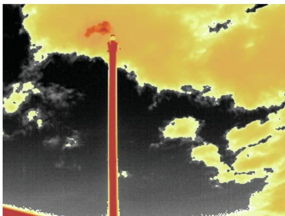
*Figure 6. Показания температуры можно использовать для контроля температуры удаляемых газов.*
