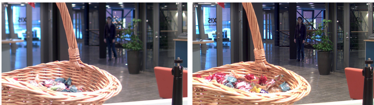
La imagen de la izquierda se captó con una cámara que utiliza un objetivo con iris tipo DC. La imagen de la derecha se captó con una cámara que utiliza un objetivo con P-Iris y muestra una profundidad de campo mayor que la imagen de la izquierda.
