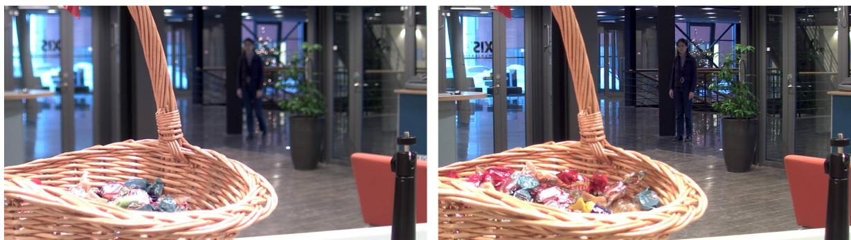
左の写真は、DCアイリスレンズを使用したカメラで撮影したものです。右の写真はPアイリスレンズを使用したカメラで撮影したもので、左の写真よりも被写界深度が深くなっています。
