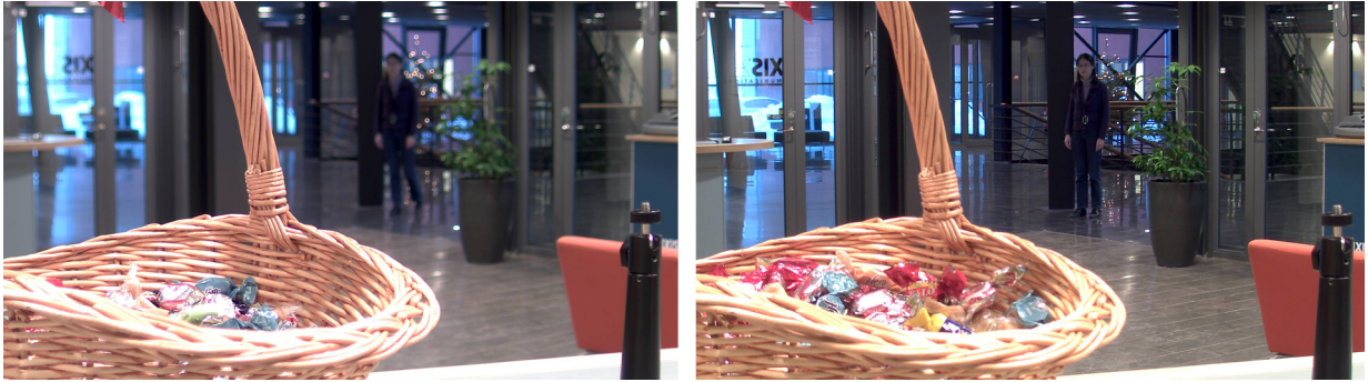
왼쪽 사진은 DC 아이리스 렌즈를 사용하는 카메라로 촬영한 사진입니다. 오른쪽 사진은 P-Iris 렌즈를 사용하는 카메라로 촬영한 사진으로 왼쪽 사진보다 피사계 심도가 깊습니다.
