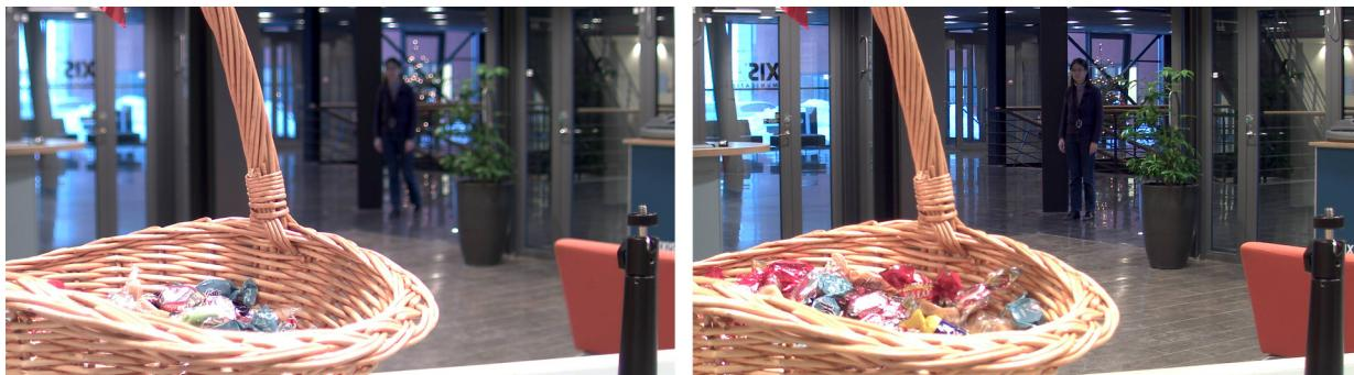
Снимок слева сделан камерой с объективом с DC-диафрагмой. Снимок справа сделан камерой с объективом P-Iris: глубина резкости выше, чем на снимке слева.
