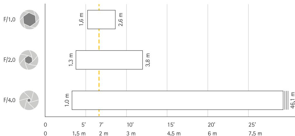
不同光圈大小的景深示例，焦距为2 m (7 ft.)。更小的光圈（即更大的f值）可以在更长的距离范围内聚焦目标。
