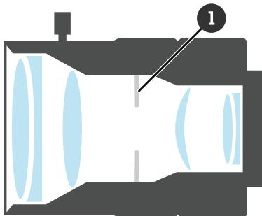
1 镜头光圈控制通过的光线量。
