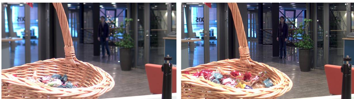
左图采用直流驱动光圈 (DC-Iris) 镜头拍摄。右图采用精确光圈 (P-Iris) 镜头拍摄，景深比左图更大。
