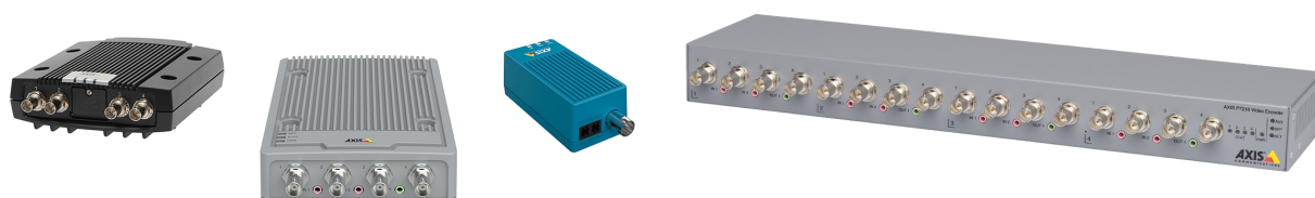
Figure 3. Ejemplos de codificadores de vídeo autónomos con conexiones de uno o varios canales a cámaras analógicas.
