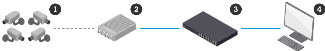
Figure 1. 従来型の同軸ケーブルを使用して、アナログカメラ (1) をビデオエンコーダ (2) に接続することができます。ビデオエンコーダによりビデオがデジタル化され、LAN経由でネットワークスイッチ (3) に送信されます。このネットワークスイッチから、ビデオがビデオ管理ソフトウェア (VMS) (4) に渡されます。
