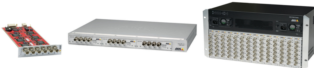
Figure 4. Przykłady modułów wideoenkoderów i obudowy obejmującej do 84 kanałów analogowych.
