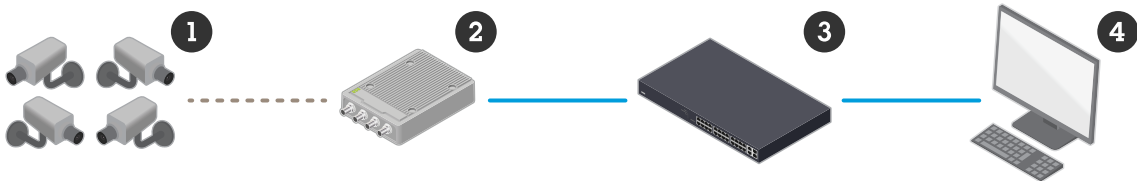
Figure 1. 模拟摄像机 (1) 可以使用传统的同轴电缆连接到视频编码器 (2)。视频编码器对视频进行数字化处理，然后通过局域网将其发送到网络交换机 (3)，交换机再将其传递给视频管理软件 (VMS) (4)。
