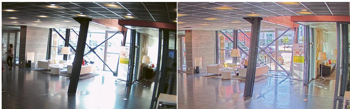
Figure 3. Escena interior con luz de fondo intensa. Comparación entre una cámara sin tecnología WDR (izquierda) y una cámara Axis con Forensic WDR (derecha).
