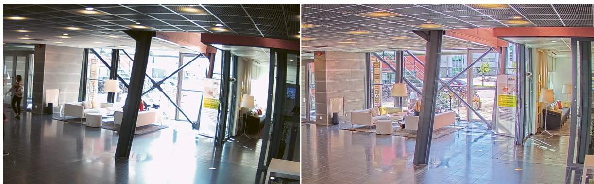
Figure 3. Scène intérieure à fort contre-jour. Comparaison entre une caméra sans fonctionnalité WDR (à gauche) et une caméra Axis dotée de Forensic WDR (à droite).
