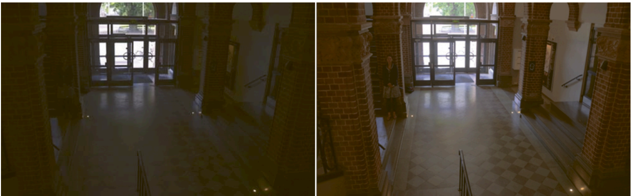
Figure 6.1 Intérieur capturé en contre-jour par des caméras dont les valeurs en dB diffèrent. L'image de droite a été prise avec une caméra dont la valeur en dB est plus faible que pour l'image de gauche, contrairement à ce qu'on pourrait croire.
