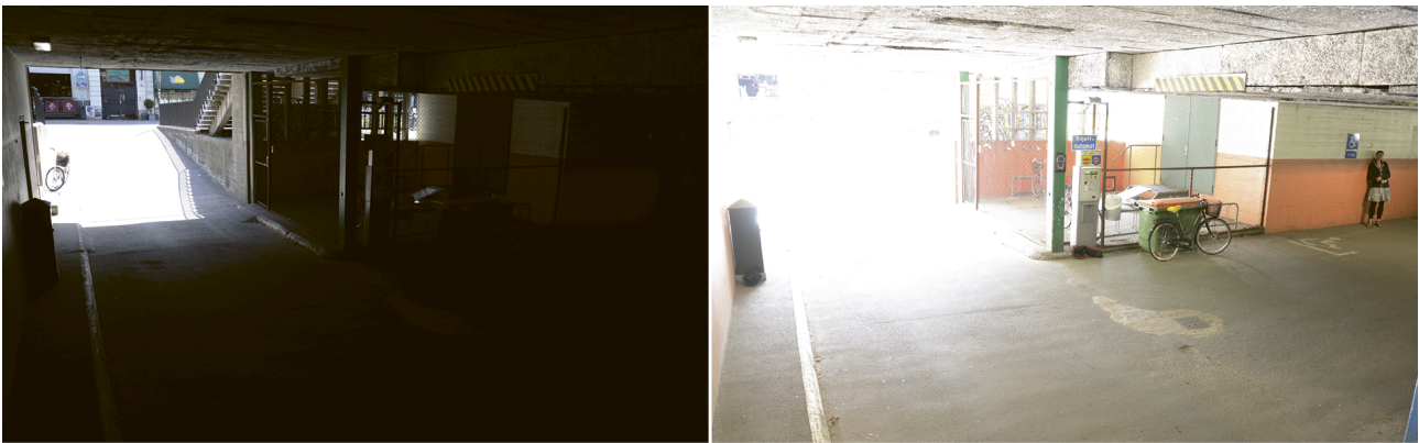
Figure 2.1 Scène de surveillance typique présentant une plage dynamique étendue, en l'occurrence l'intérieur d'un parking couvert et son entrée. Les deux images sont prises avec des temps d'exposition différents, plus court à gauche et plus long à droite.
