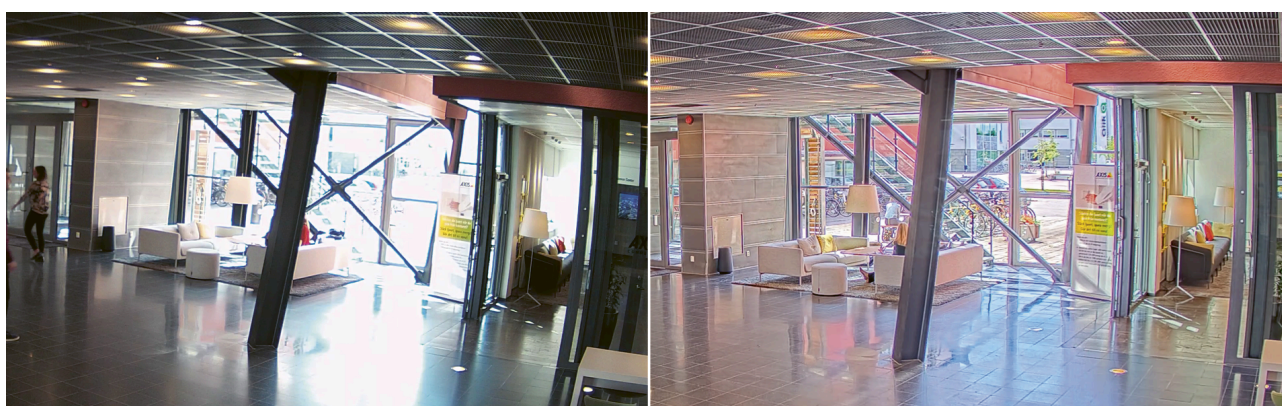
Figure 5.1 Scène intérieure à fort contre-jour. Comparaison entre une caméra sans fonctionnalité WDR (à gauche) et une caméra Axis dotée de Forensic WDR (à droite).
