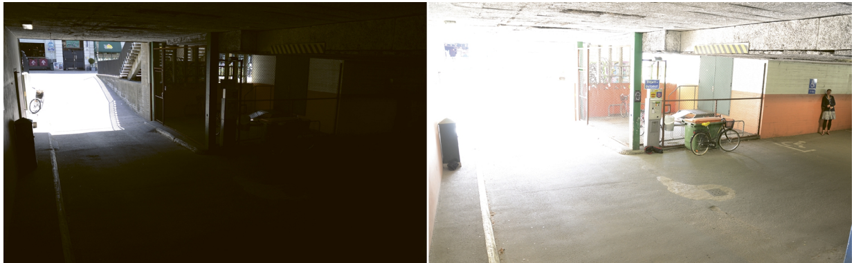
Figure 1. 광역 역광 보정(WDR)을 통한 일반적인 감시 장면: 주차장 내부와 입구. 두 이미지는 노출 시간을 다르게 해서 촬영했으며 왼쪽은 노출 시간이 짧은 이미지이고 오른쪽은 긴 이미지입니다.
