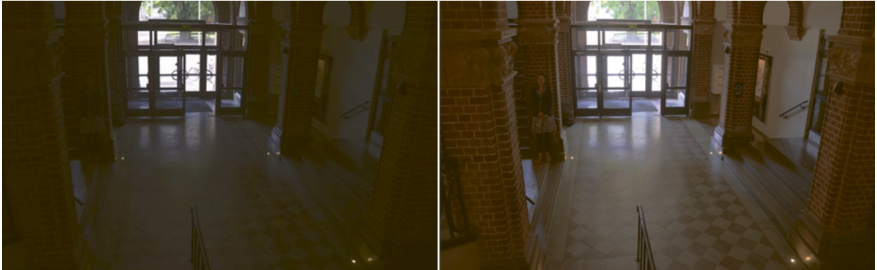
Figure 4. 다른 dB 값의 카메라로 캡처한 역광 상태 실내. 예상과 달리 오른쪽 이미지가 왼쪽 이미지보다 지정된 dB 값이 낮은 카메라로 촬영한 이미지입니다.
