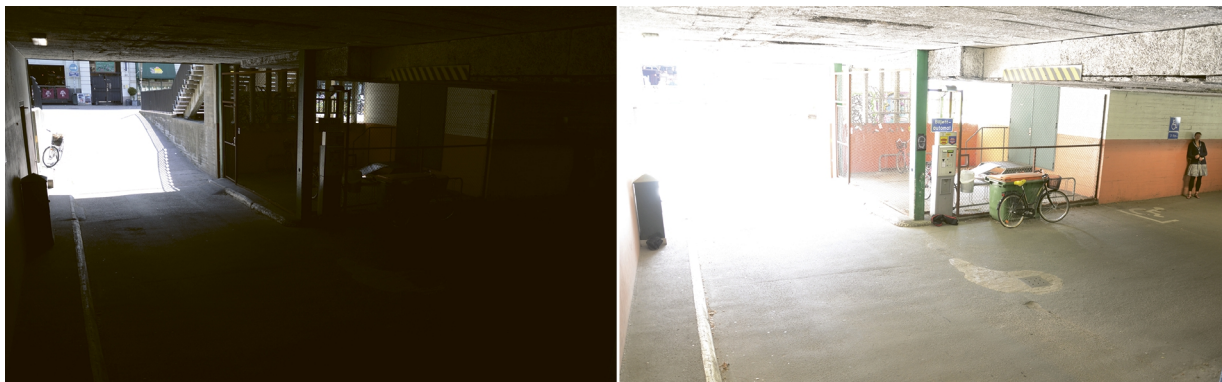
Figure 1. Typowa scena objęta dozorem, w której występuje szeroki zakres dynamiki: wnętrze zadaszonego parkingu z wjazdem. Przedstawione dwa obrazy zostały zarejestrowane przy użyciu różnych czasów ekspozycji: krótszego w przypadku obrazu po lewej i dłuższego w przypadku obrazu po prawej stronie.
