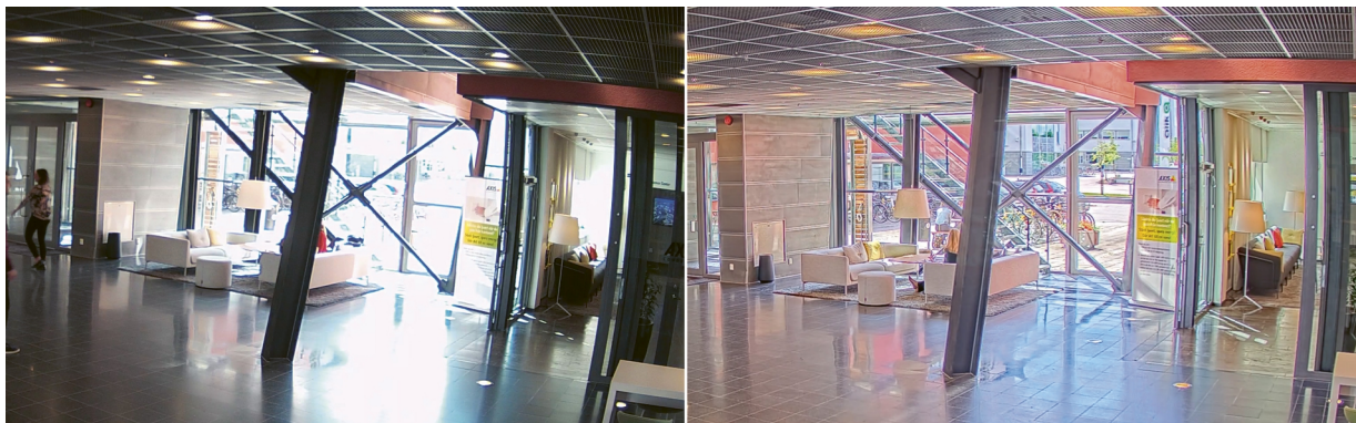
Figure 3. Scena wewnętrzna z silnym oświetleniem tylnym. Porównanie kamery bez funkcji WDR (po lewej) z kamerą Axis wyposażoną w technologię Forensic WDR (po prawej).
