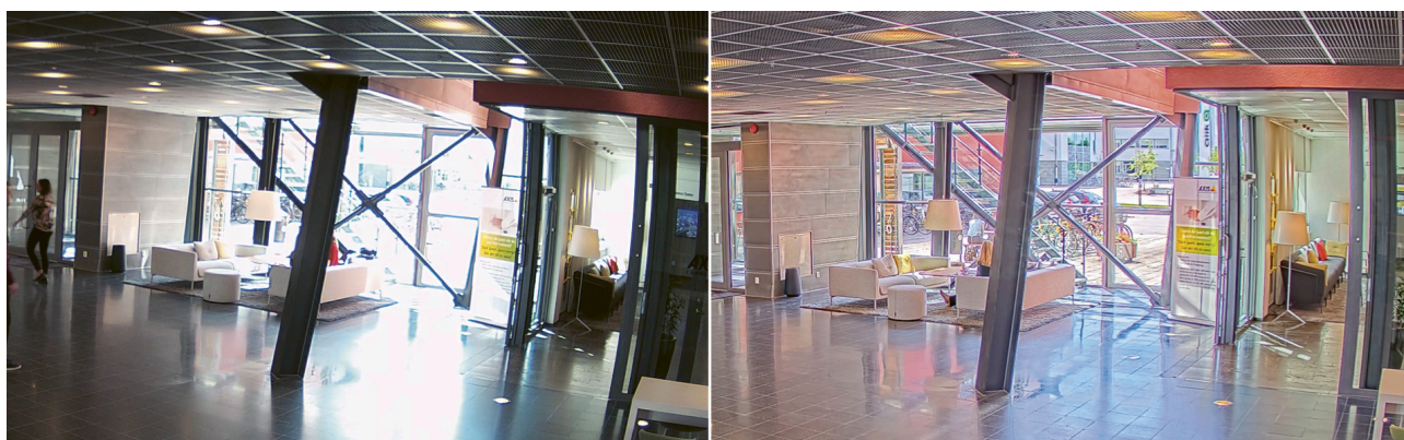
Figura 5.1 Cena em um ambiente interno com iluminação de fundo intensa. Comparação entre uma câmera sem capacidade de WDR (esquerda) e uma câmera Axis com Forensic WDR (WDR Forense) (direita).
