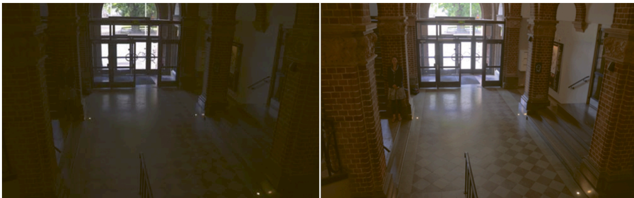
Figura 6.1 Area interna com iluminação de fundo capturada por câmeras com diferentes valores de dB. A imagem à direita a seguir foi gerada utilizando uma câmera com um valor de dB especificado menor do que o da imagem à esquerda, contrariando as expectativas.
