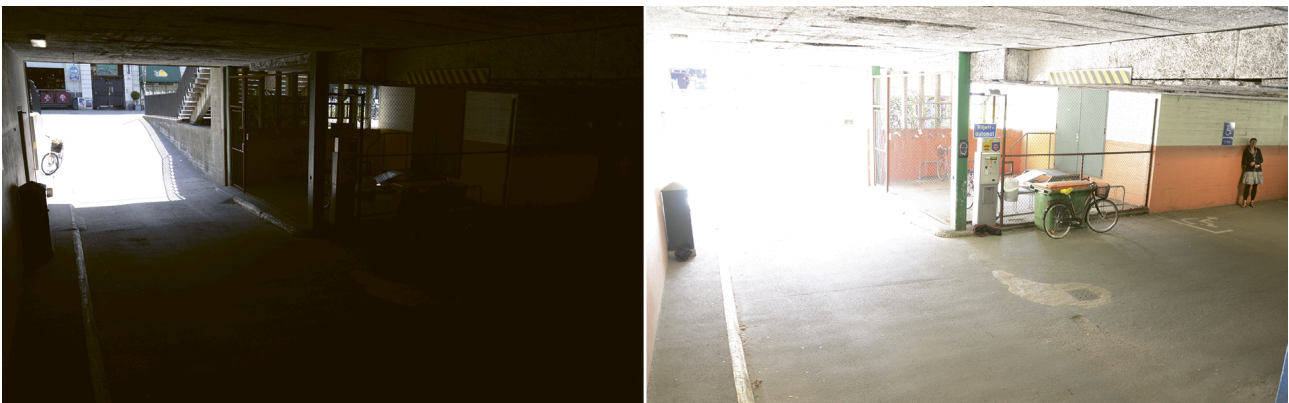
Figura 2.1 Uma típica cena de monitoramento com amplo alcance dinâmico: o interior de um estacionamento e sua entrada. As duas imagens foram geradas usando diferentes tempos de exposição, menor na imagem à esquerda e maior na imagem à direita.
