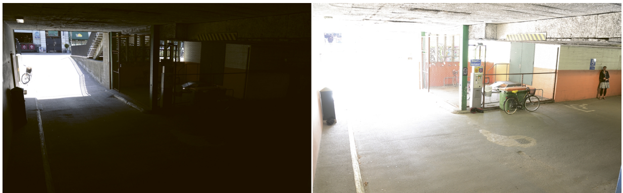
Figure 1. 典型的宽动态范围监控场景：带入口的车库内部。这两个图像采用不同的曝光时间拍摄，左图的曝光时间短，右图的曝光时间长。
