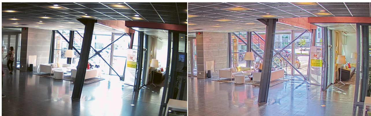
图 5.1 强背光下的室内场景。不带宽动态功能的摄像机（左边）与安讯士Forensic WDR（猎影超宽动态技术）摄像机（右边）的对比。
