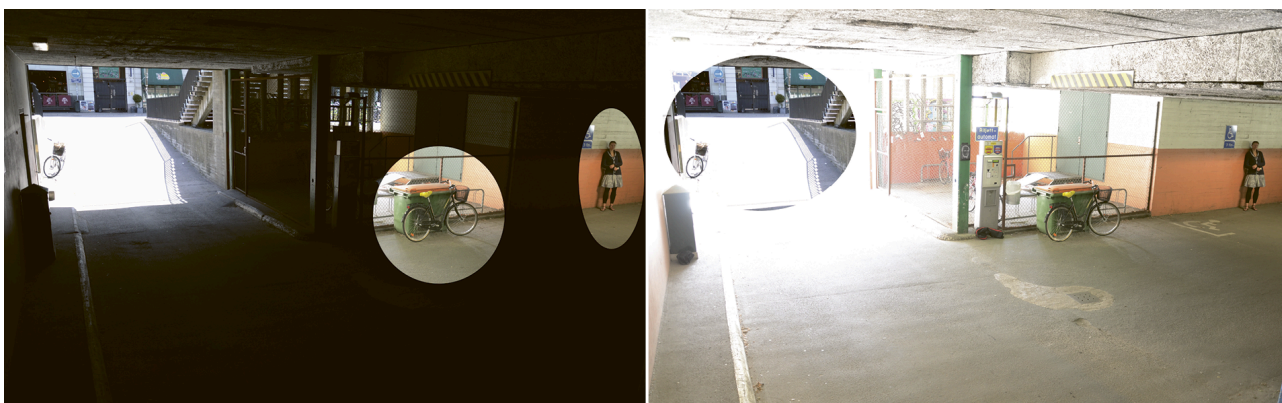
图 2.2 场景与之前相同。左图显示了短曝光时间所丢失的细节。右图显示了长曝光时间所丢失的细节。
